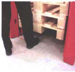
*Photozellen überwachen das Arbeitsfeld des Magazins und senden Signal zur Anhaltung des Magazins, wenn eine Palette nicht völlig in das Palettenmagazin hineingeführt oder aus dem Palettenmagazin hinausgeführt ist, oder wenn z. B. ein Fuß in das Arbeitsfeld gerät.*
