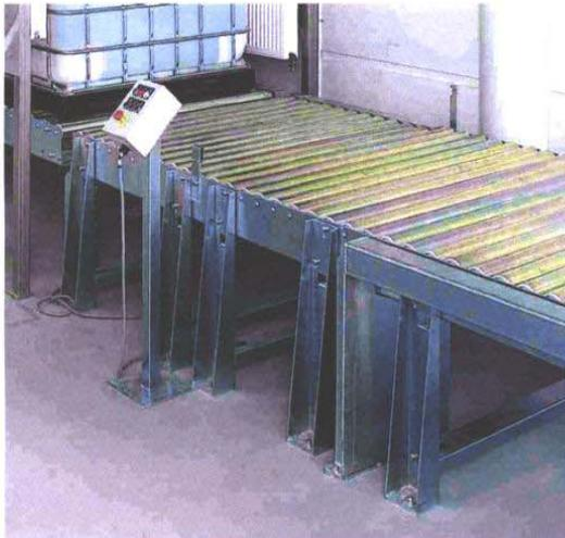
Angetriebene Palettenrollenbahnen bei der Firma Coloplast in Dänemark.
