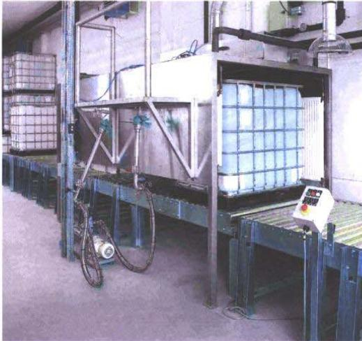
Palettenbahnsystem zur Handhabung von Paletten beladen mit Behältern mit Flüssigkeiten bei der Firma Coloplast in Dänemark.
