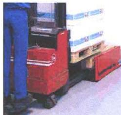
*Der Palettenwechsler kann auf einfache Art und Weise auf die konkrete Palettengröße eingestellt werden, indem der Abstand zwischen den beiden Seitenmodulen verändert wird. Die Module werden anschließend am Boden verschraubt.*
